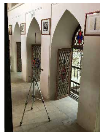
تصویر ۳. برداشت میدانی از سرعت هوا در خانه گلشن. مأخذ: آرشیو نگارندگان. تصویر ۴. بادسنج تستو مدل ۴۰۵۱. مأخذ: آرشیو نگارندگان.
