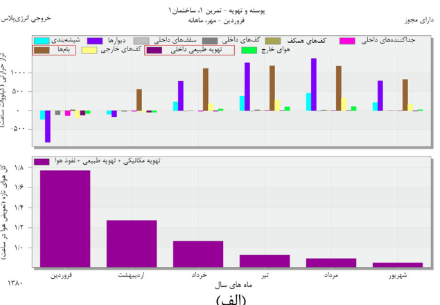
تصویر ۹. الف) نمودار میزان تعادل حرارتی از طریق تهویه طبیعی و سقف خارجی و میزان کل هوای تازه در سقف سفال پوش، ب) نمودار میزان تعادل حرارتی از طریق تهویه طبیعی و سقف خارجی و میزان کل هوای تازه در سقف گالی پوش. مأخذ: نگارندگان.
